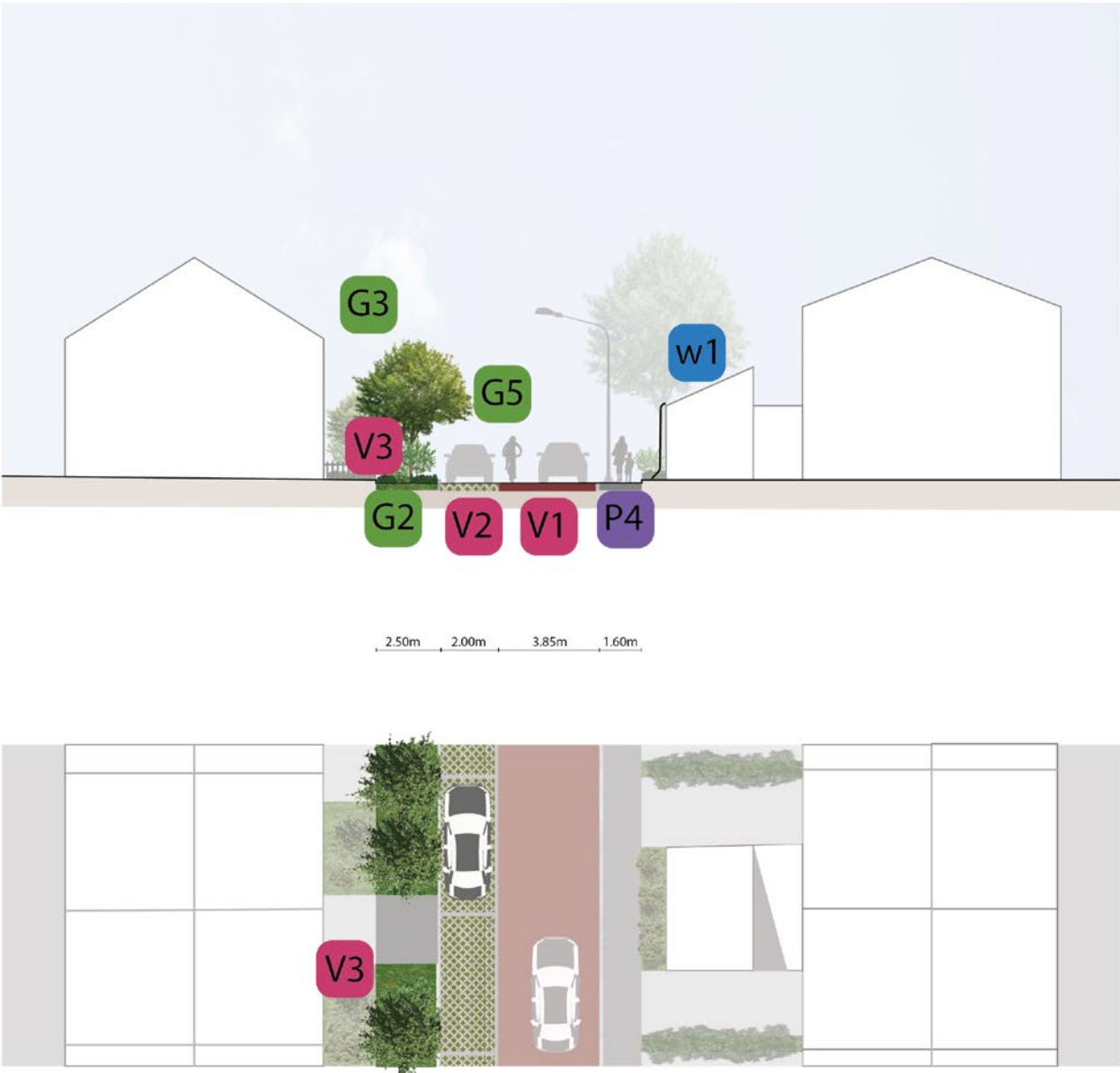
Voorbeelduitwerking vergroening profiel woonstraat 9.95m
